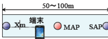
図4 1次元測位方式
