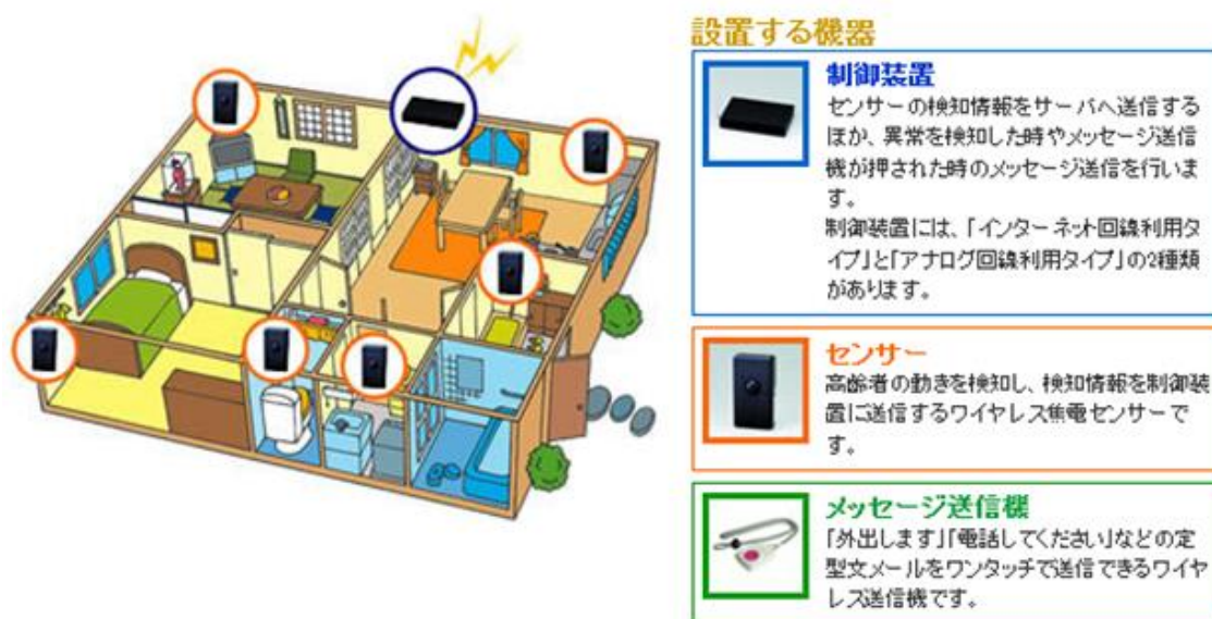
図 4.高齢者宅内の機器設置イメージ
