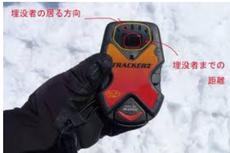
図2.2 雪崩ビーコンのイメージ図
