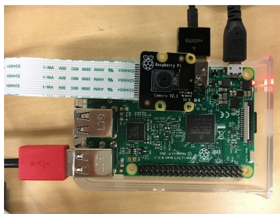
図 4.2 ラズベリーパイとカメラモジュール
