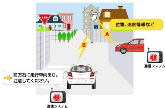
図 2.3 路車間通信システム
