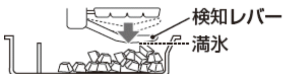
図 2.2：検知レバーの仕組み(*1)
