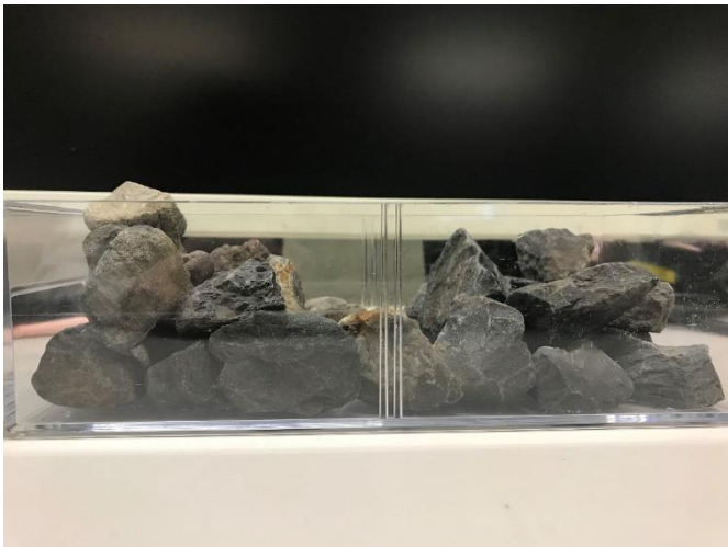
図 4.7 パターン 6 の小石の状態(中央が少ない状態)
