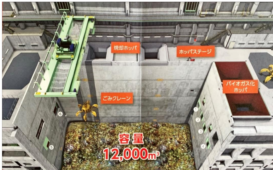
図1 ごみピット(さすてな京都の資料より引用)
