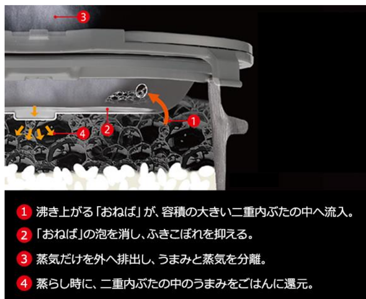
図 2.2.2.1 NJ-AWB10 の仕組み([7]から引用)
