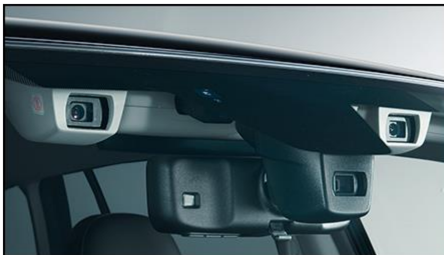
図2：アイサイトのステレオカメラシステム
