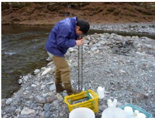
図 3.1.3.4 透明度の測定
