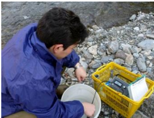
図 3.1.3.3 溶存酸素濃度の測定
